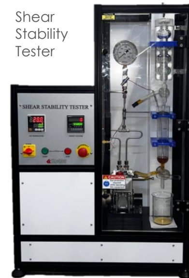
Стенд для испытаний устойчивости масла к разложению при прохождении через форсунку Bosch (ASTM D7109)
